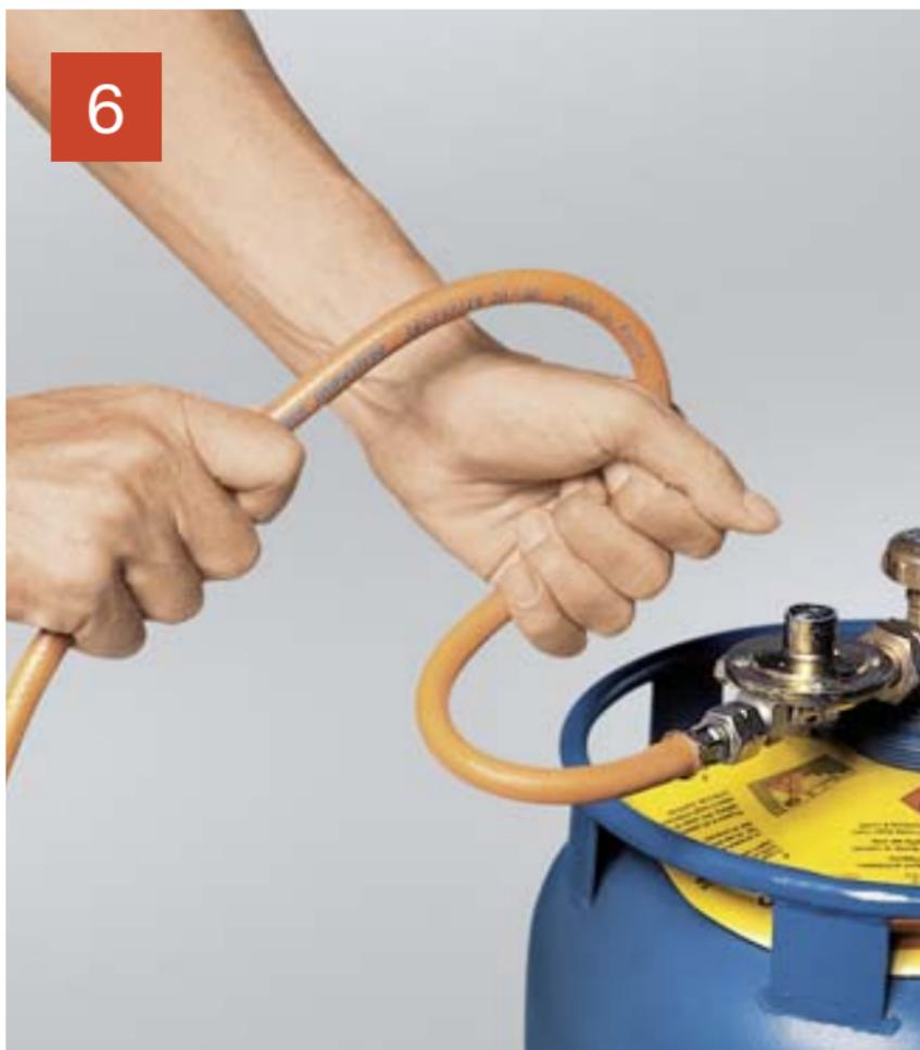
Beschädigte, spröde oder rissige Schläuche sind auszuwechseln. Führen Sie Dichtheitskontrollen mit schaubildenden Mitteln aus – keinesfalls mit einer offenen Flamme!
